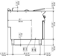
Electrical inlet (power) Equipotential screw
